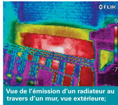
Vue de l'émission d'un radiateur au travers d'un mur, vue extérieure;
